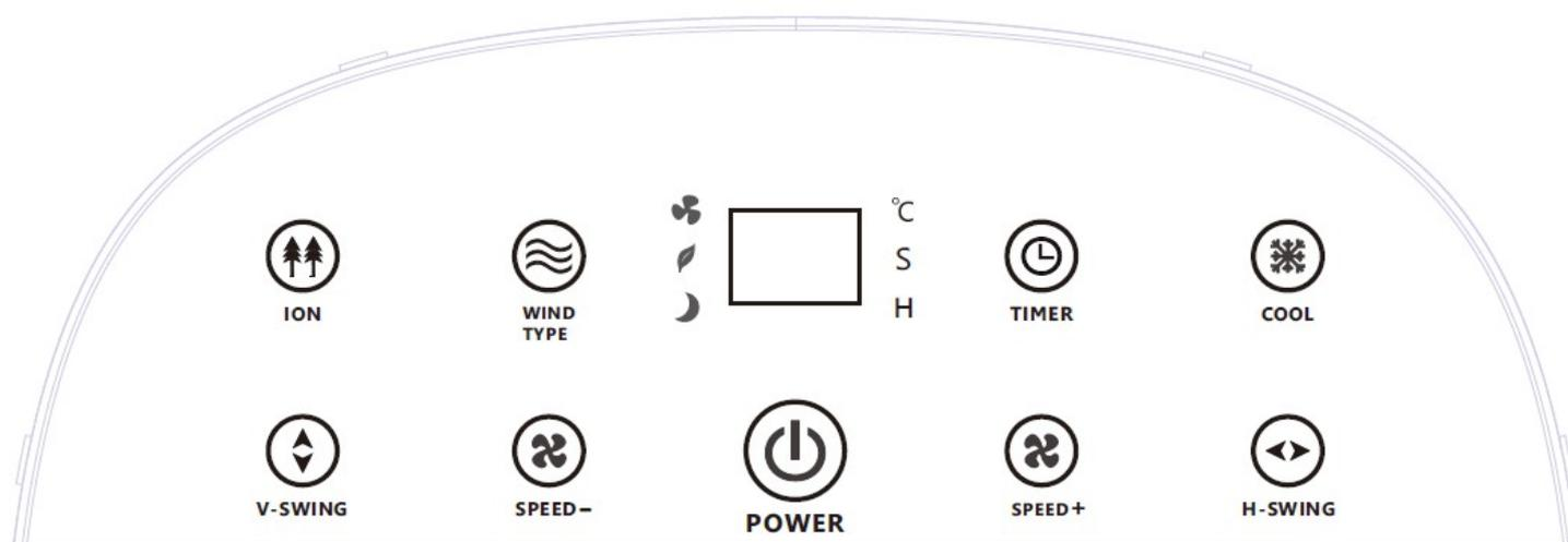
1. **POWER:** Drücken Sie den Power-Knopf, um den Kühler einzuschalten. Die horizontalen Lamellen öffnen sich und das Gerät läuft nach vier Sekunden mit der Lüftergeschwindigkeit 5. Auf dem Display wird „05“ angezeigt und die Anzeige "S" leuchtet auf.
